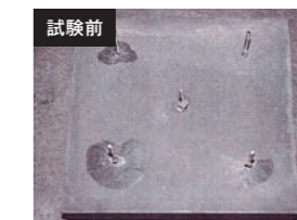
試験前 コンクリート板 深さ30mm施工での試験
