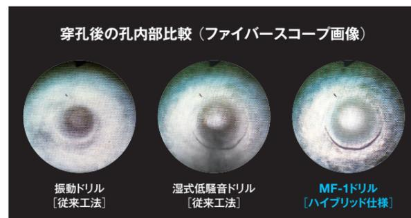
振動ドリル穿孔後にエアプロアにて清掃後の孔内部は、空隙部に粉塵が詰まり、さらに穿孔時に発生するドリルビットの摩擦熱にて孔壁部に粉塵が固着した状態です。結果、樹脂との接着性が低下します。
