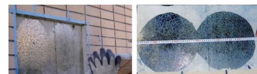
■HQ工法 実施工現場(文化財)におけるステンレスアンカーピン引抜き試験状況
