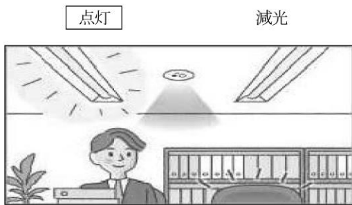
図-2 外光日射補正 + 在席感知の制御
