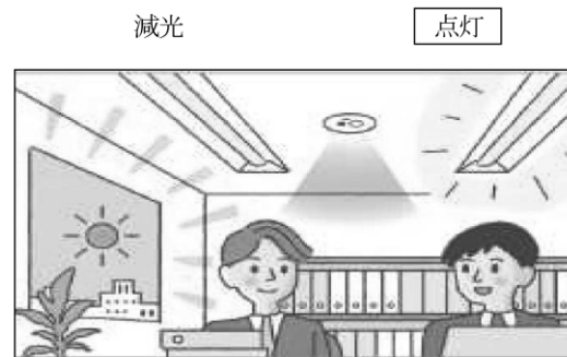
図-1 外光日射補正の制御 (従来)
