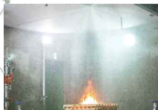
スプリンクラー消火実験
