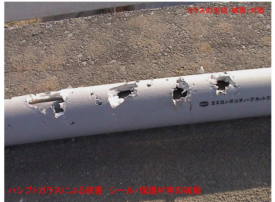
ハシブトガラスによる被害 シール・保護材等の破損
