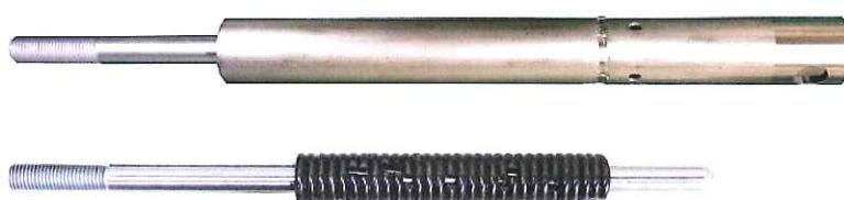
自動車用のばねに使用される高強度材料で製作したC形リングを数十個ロッドに圧入しながら積層し、シリンダー(外筒)に装填したシンプルな構造です。
