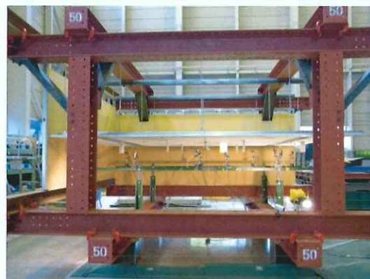
振動台にセットされた試験体
