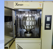
促進耐候性試験状況
